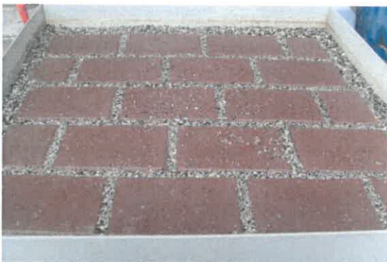
Bild 3: Im Testmodell eingebautes Drain-Pflasters
