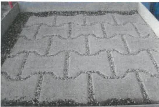
**Bild 3: Im Testmodell eingebautes DT-Drain-Pflasters**
