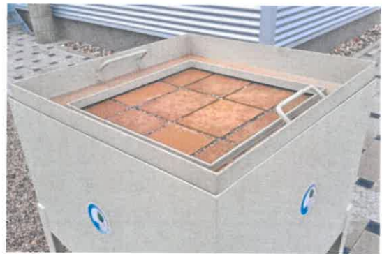
Bild 2: Rahmen mit Öffnung 60 x 60 cm zur Begrenzung und Abdichtung der zu prüfenden Pflasterfläche
