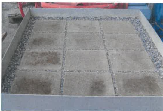
Bild 3: Im Testmodell eingebautes Pflaster Rombula Drain
