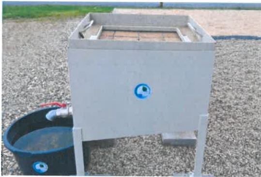
Bild 1: Testmodell zur Prüfung der Versickerungsfähigkeit von Pflaster mit einem Systemaufbau
